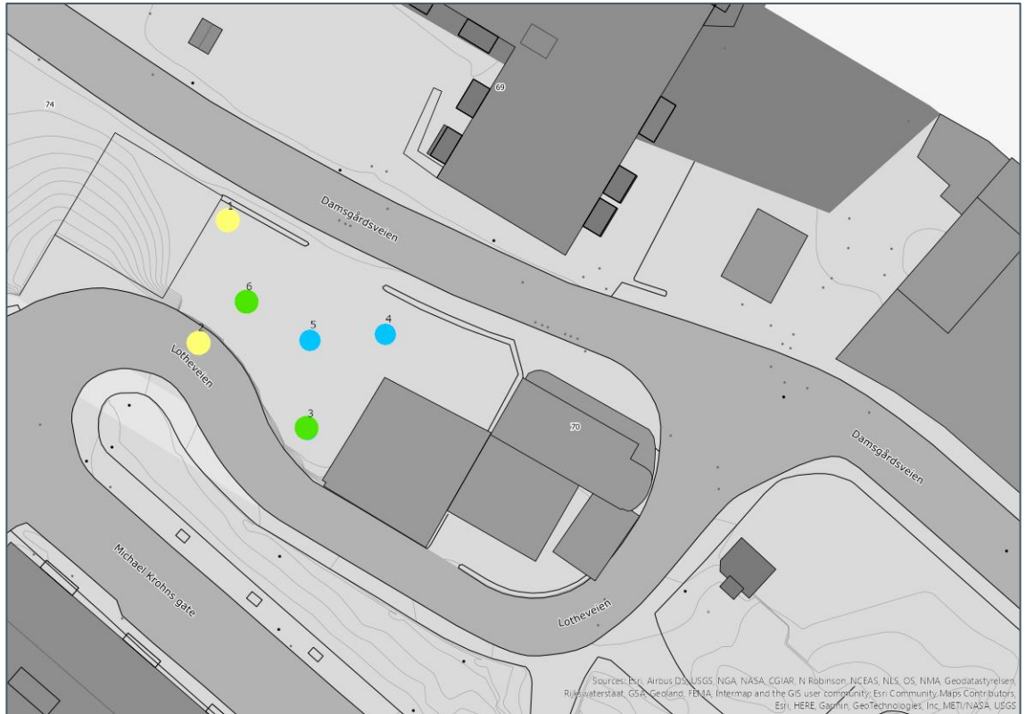
Figur 4 En kartfremstilling av prøvepunktene, farget etter påvist tilstandsklasse i henhold til fargekoder for helsebaserte tilstandsklasser (TK) for forurenset grunn (Miljødirektoratet, 2009).
