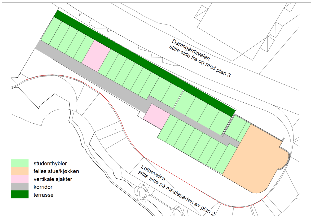
Figur 22: Funksjonsprogrammering av en typisk studentbolig som strekker seg over én etasje i volumutkastet. Her oppnår man tilgang til stille side på over 70% av oppholdsareal.
