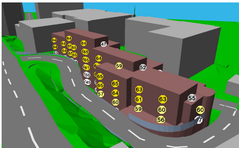
Figur 20b: Støyforhold på fasade mot Lotheveien. Utkast fra arbeidsmøte med akustiker på Sweco.
