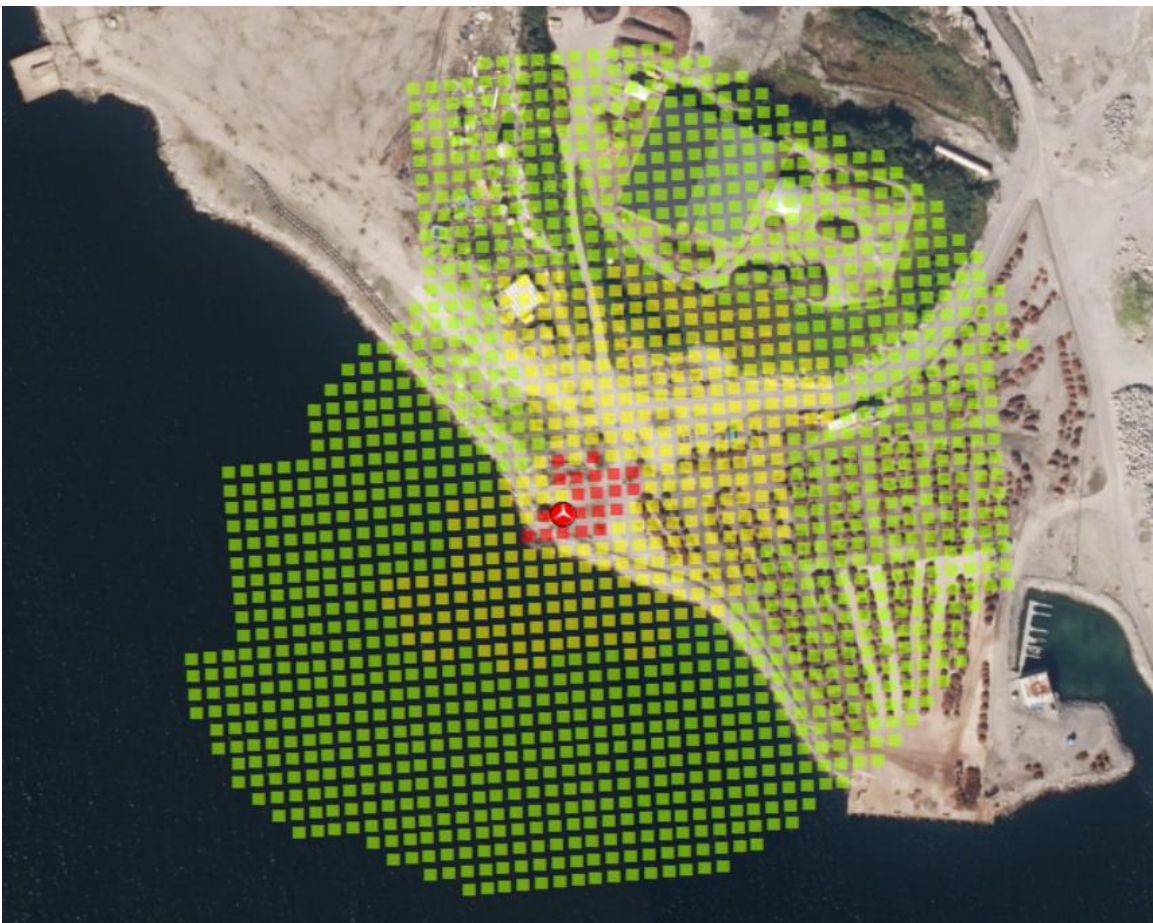
Figur 17: Illustrasjon over raud, gul, og grøn iskastsone Kjelde: Meventus.
