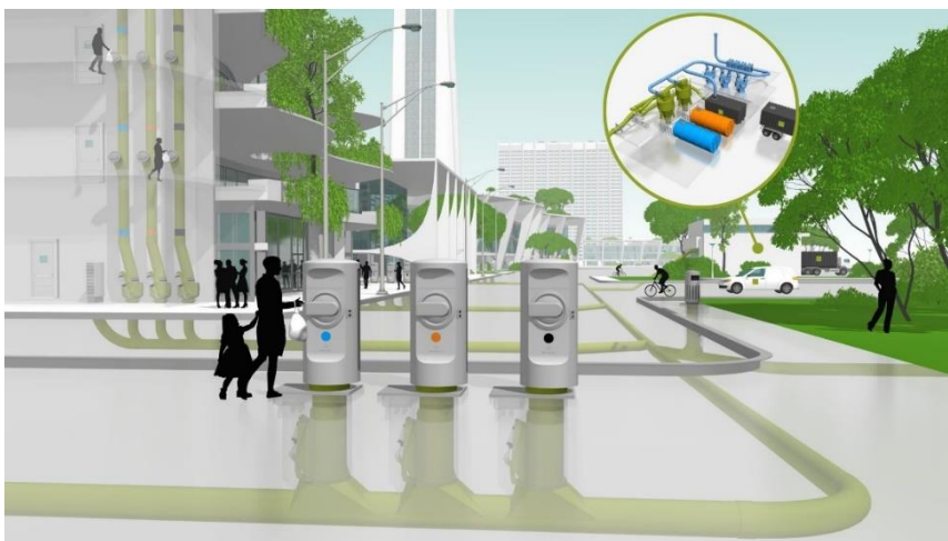
Figur 5: Prinsippskisse - stasjonært avfallssug. Kilde: Envac
