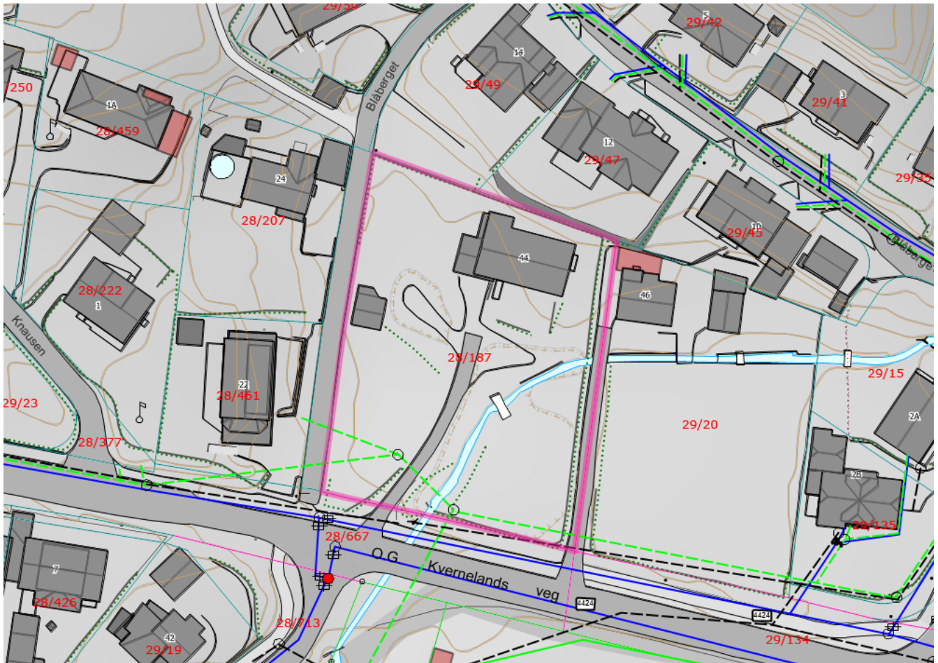
Figur 3 Situasjonskart over vann og avløp
