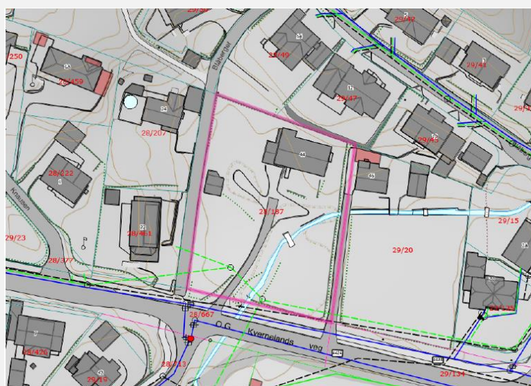
Figur 3 Situasjonskart over vann og avløp
